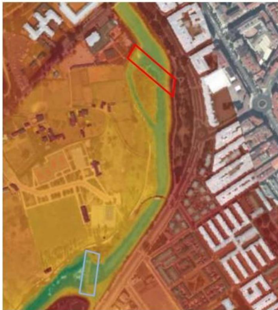
Figura 10: composición MDT – ortofotografía aérea, donde puede apreciarse como el azud de La Julia (abajo, en azul) aparece en los datos de batimetría, mientras que el azud de Mantas David Rodríguez (arriba, en rojo), no lo hace.
