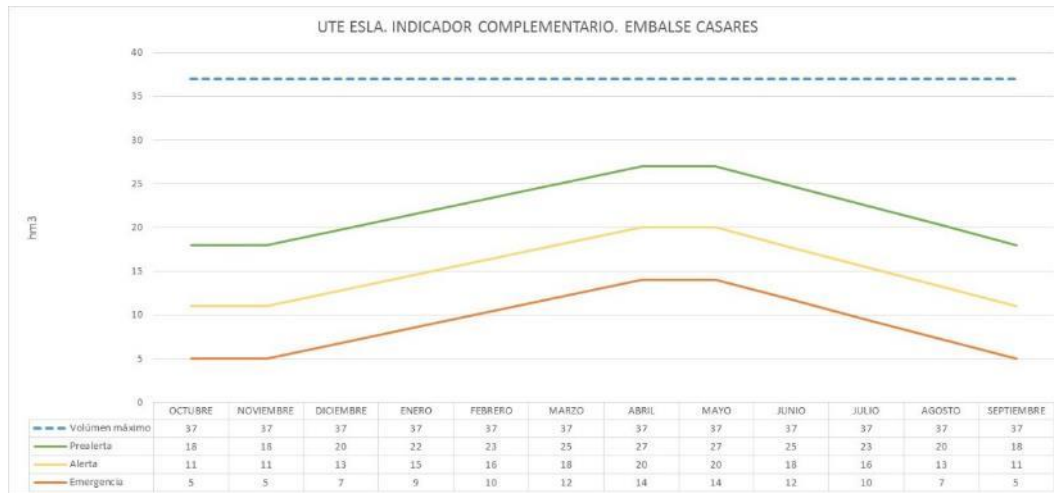
Figura 175. Umbrales mensuales para cada escenario para el volumen almacenado en el embalse de Casares.
