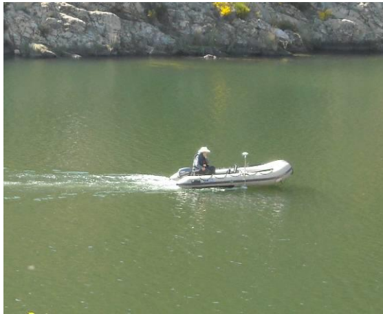
Figura 5. Toma de datos del cauce mediante ecosonda acoplada a embarcación
