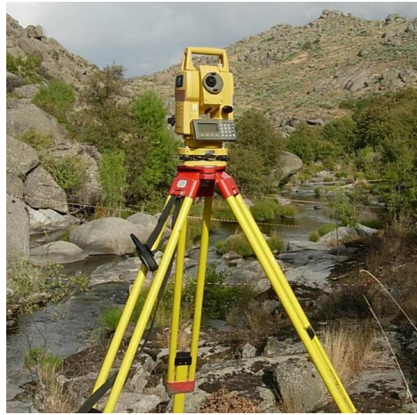
Figura 4. Toma de datos de topografía mediante Estación Total
