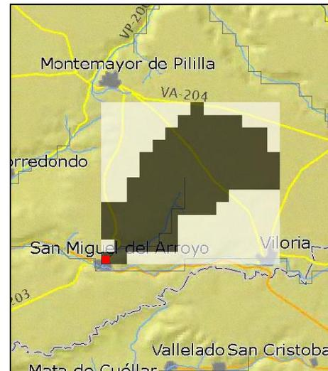
Figura 9- Cuenca correspondiente al tramo analizado a partir de la aplicación CauMax
