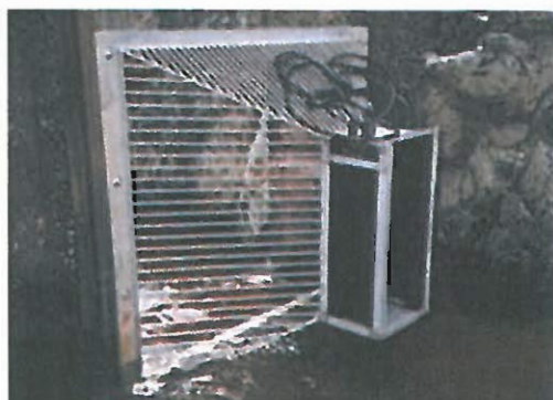
Bastidor para el guiado de los peces y escáner infrarrojo Riverwatcher Fish Counter. Fte: http://vaki.is/Products/RiverwatcherFishCounter/BasicUnits/
