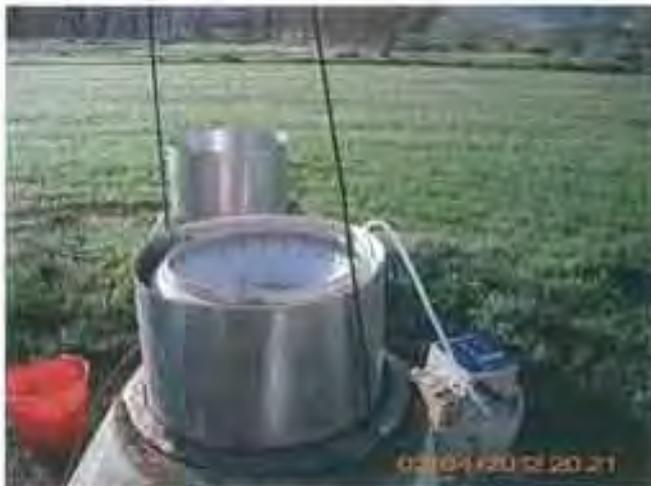
Figura 12.- Final de Colector Industrial. Colector 6. Detalle tomamuestras
