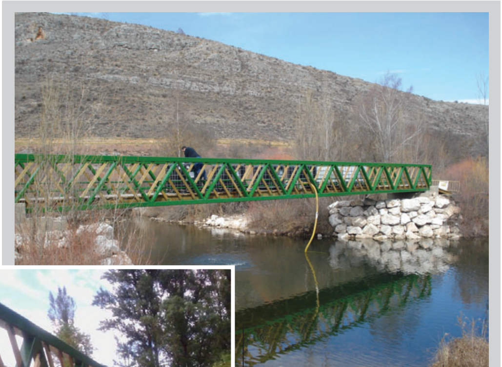
Prueba de carga estática de la pasarela
