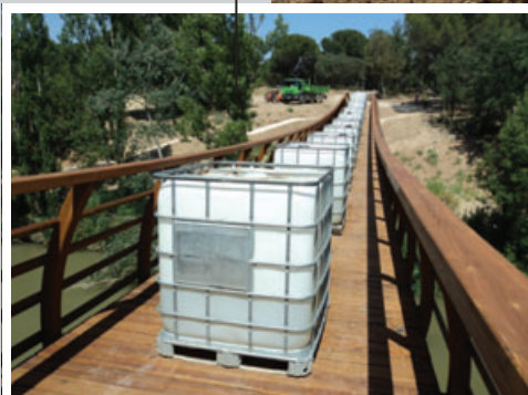
Prueba de carga estática
