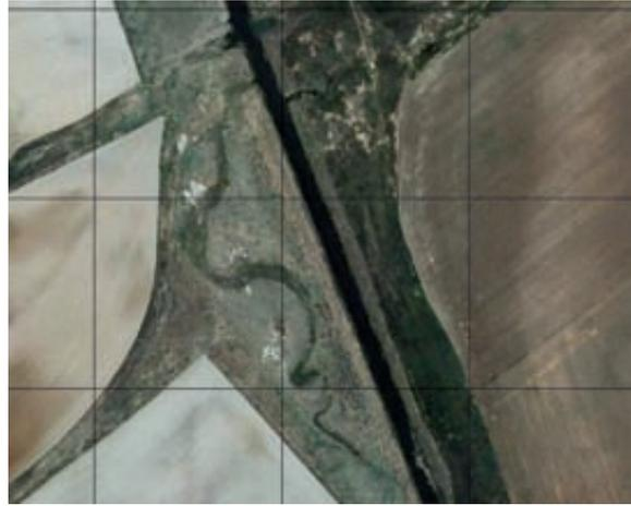
Un ejemplo demostrativo de este tipo de actuaciones lo constituye la eliminación de mota en el río Zapardiel en la provincia de Valladolid donde se aprecia con claridad la barrera paralela al cauce y el estado final tras la actuación. La zona degradada tras la intervención tendrá una rápida recuperación como consecuencia de los desbordamientos naturales del río.
