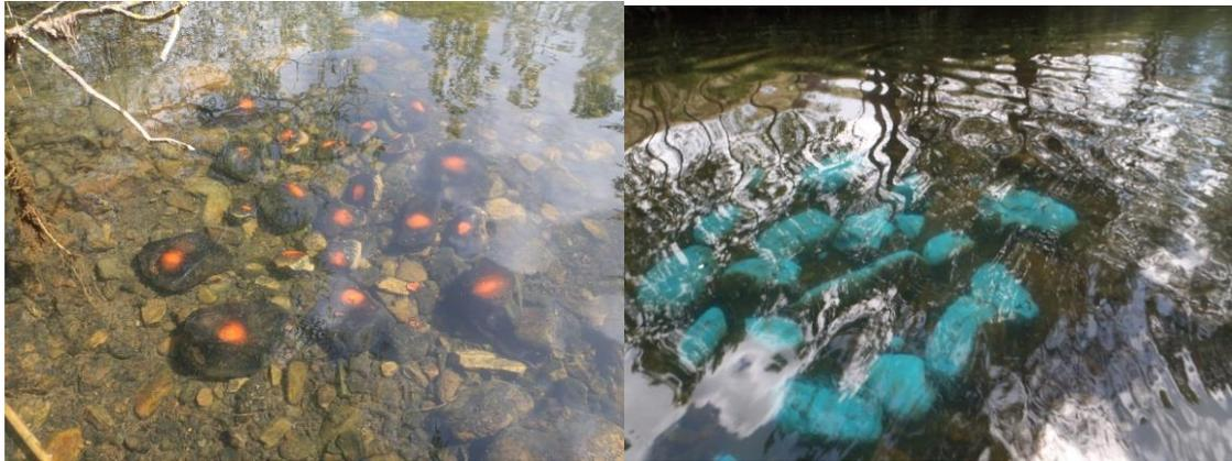
Fraciones de diferentes tamaños de gravas pintadas para medir parámetros hidráulicos en el ensayo de caudal generador del embalse de La Requejada
