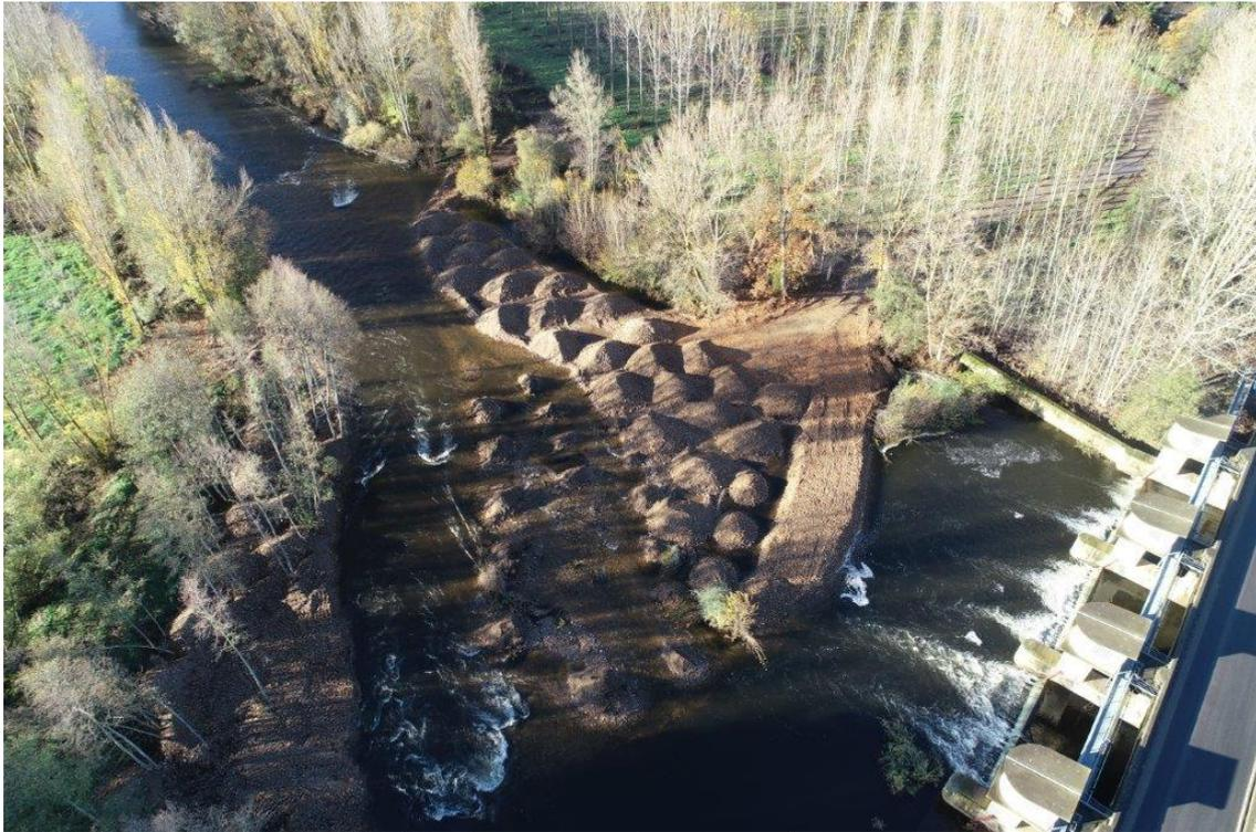
Depósitos de parte de los sedimentos extraídos del embalse que forma el azud de Santa Marina del Rey, en el río Órbigo, y depositados aguas abajo del mismo para que los remobilice el río en crecida
