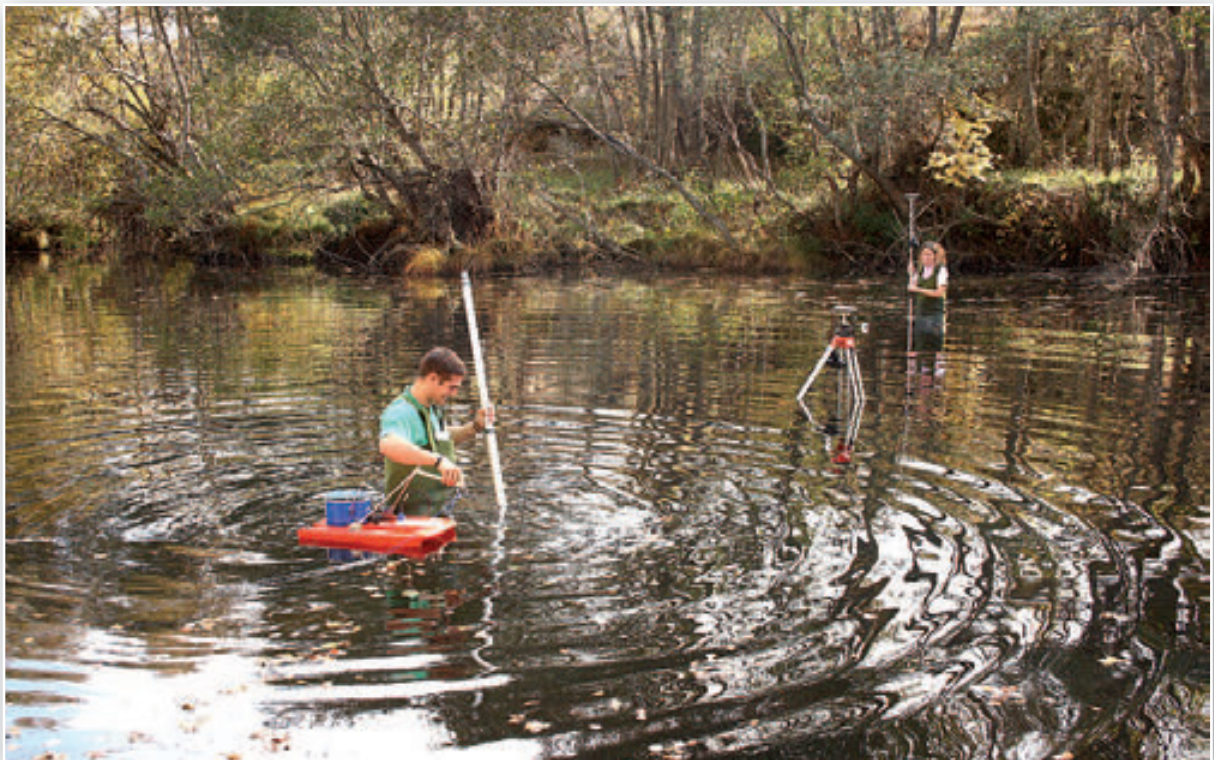
Río Negro. Otero de Centenos. Zamora. Proceso de medición de una sección transversal.
