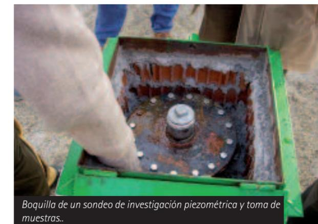
Boquilla de un sondeo de investigación piezométrica y toma de muestras.
