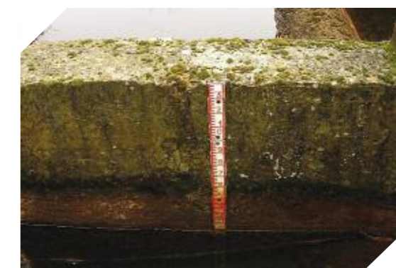
Fotos 5.1. y 5.2. Aforo manual directo en el río Carrión en Villoldo (Palencia) y escala en una sección de control foronómico
