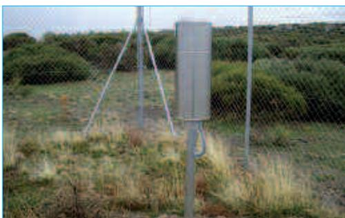
Foto 5.6. Pluvionivómetro en La Herguijuela (Ávila).
