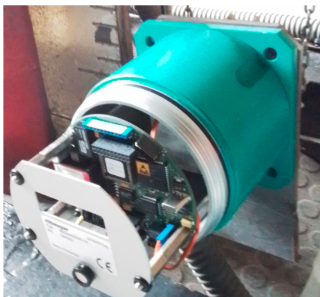
Figura 7. Sistema de cadena y polea sobre válvula con encoder óptico(verde). Interior del encoder.
