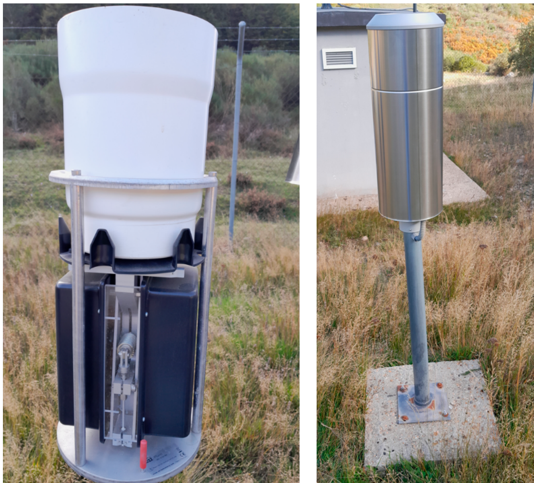
Figura 19. Interior y exterior de un nivómetro de pesaje.
