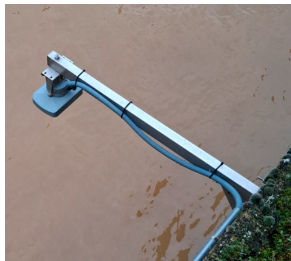
Figura 17. Radar para la medida de nivel en estación de aforo.
