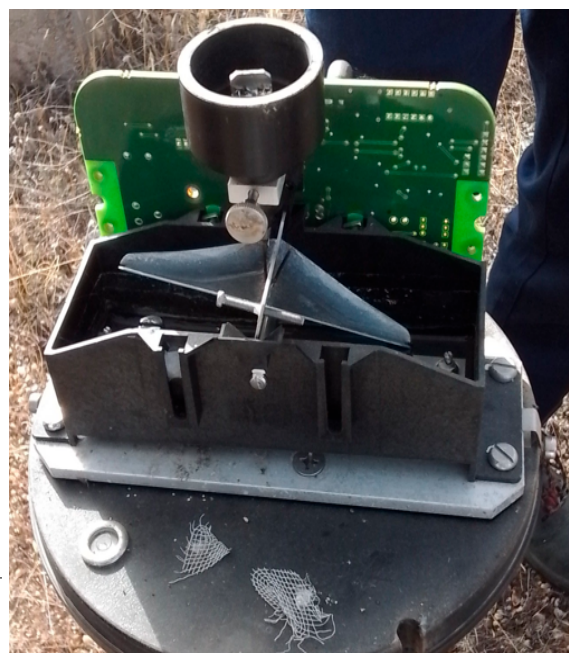
Figura 18. Interior de un pluviómetro de balancín durante su mantenimiento.
