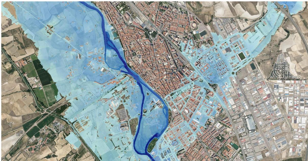
Figura 18. Ejemplo de calados obtenidos en la modelización de los subtramos ES020/0013\_05-1800005-06, ES020/0013\_05-1800005-07 y ES020/0013\_05-1800303-01 (Palencia).
