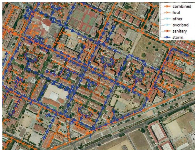
Ilustración 15. Representación de modelos hidrodinámicos de saneamiento. Fuente: EMASESA.
