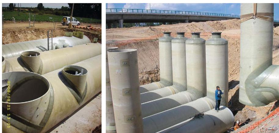
Ilustración 62. Tanques de tormenta tubulares / Tanques de tormenta prefabricados modulares (AmiStorm Tank) en Poliéster Reforzado de Fibra de Vidrio (PRFV), para construir desde pequeños depósitos a grandes tanques de retención. Fuente: AMITECH SPAIN, S.A. e Hidrostantk.
