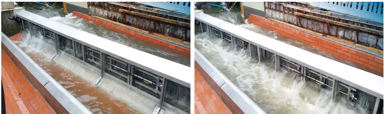
Ilustración 74. Funcionamiento de un Tamiz de aliviadero de limpieza automática tipo PEINE con sistema de limpieza lateral. Fuente: HidroStank.
