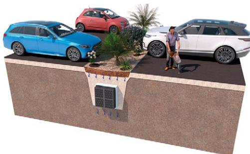
Ilustración 88. La escorrentía pluvial, previamente gestionada y filtrada en un SUDS, en este caso, un Parterre inundable (Área de biorretención), puede ser almacenada en un depósito construido con celdas o cajas drenantes. Fuente: SUDS S.L - Atlantis.
