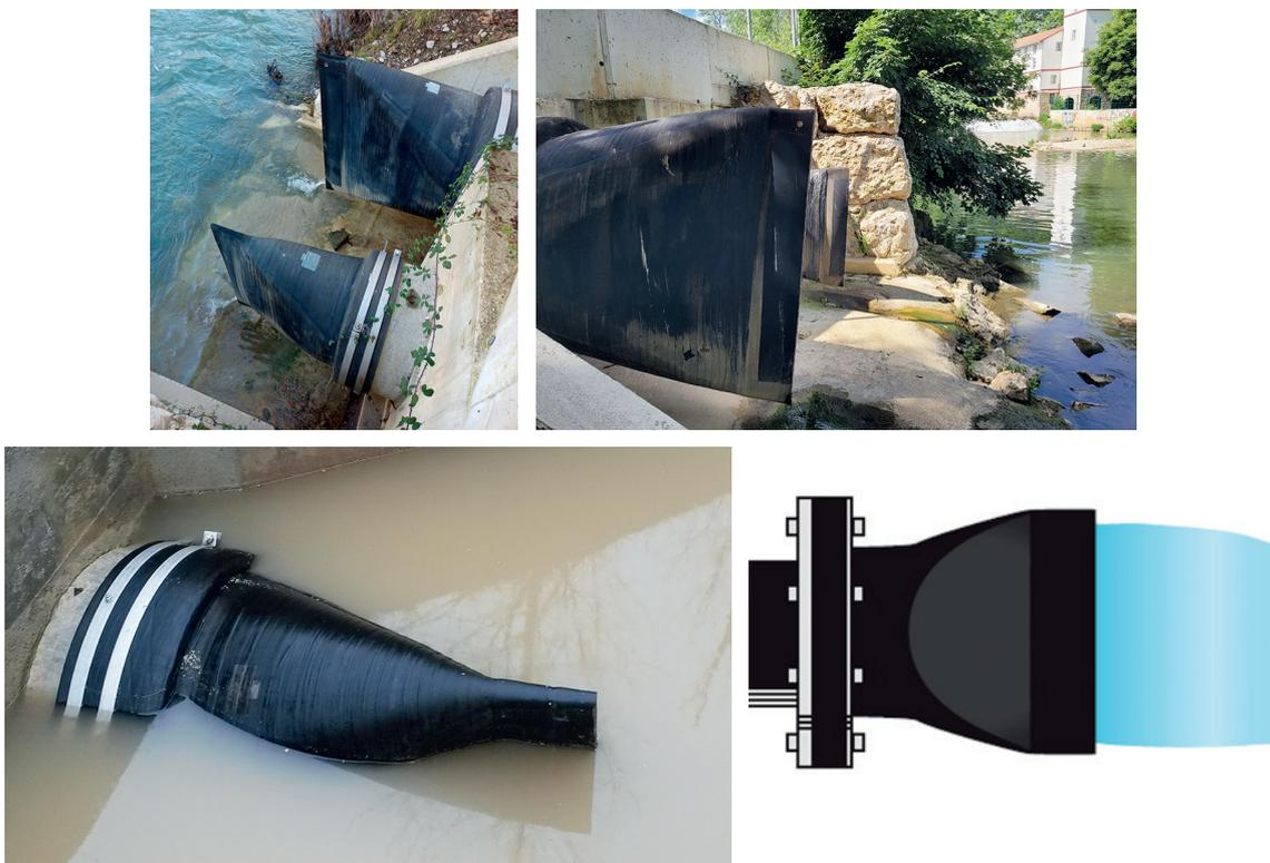
Ilustración 24. Las válvulas antirretorno tipo pico pato o pinza controlan los retornos de agua de las EDAR o de las crecidas de ríos o mareas. Son pasivas al paso del flujo de agua a su través y no requieren de ninguna fuente de energía. Sustituyen a las clapetas antirretorno ante la presencia de sólidos ya que se cierran incluso con sólidos atrapados en su interior. Cortesía de HidroStank.
