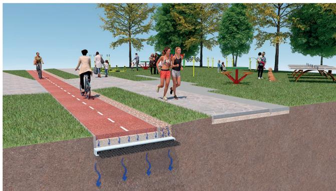
Ilustración 47. Representación de un pavimento permeable con infiltración al terreno. Fuente: SUDS S.L - Atlantis.
