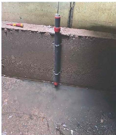
Ilustración 42. Sonda multiparamétrica (Nivel; Temperatura; PH; Redox; Conductividad; Oxígeno disuelto; Turbidez) instalada en un aliviadero del sistema de saneamiento. Fuente: CleanWater, Microcom y Dosatronic Iberia.
