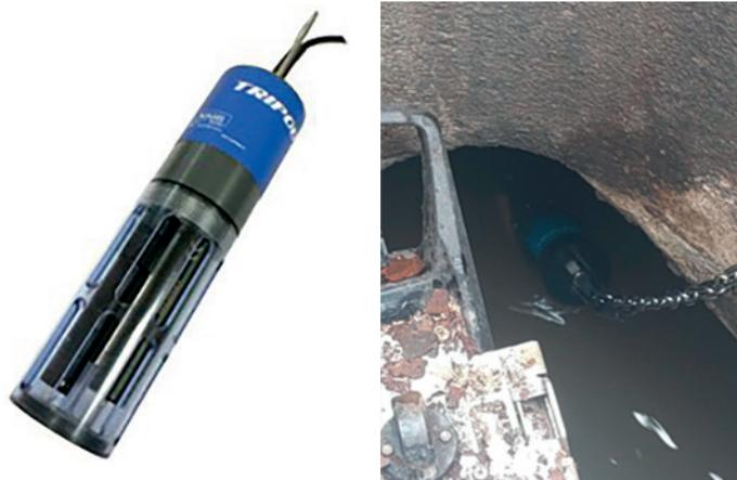
Ilustración 16. Sonda multiparamétrica: pH (pH; Redox; temperatura), conductividad [salinidad; Sólidos disueltos (TDS)] y turbidez (Turbidez; Sólidos en suspensión; temperatura). Fuente: LACROIX SOFREL.
