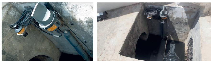
Ilustración 13. Control cuantitativo y cualitativo de los VDSS: Conjunto de sensor de nivel por ultrasonidos (US) para medir el caudal, sin contacto + Sensor de conductividad + Sensor de pH en vertedero triangular + Registrador de Datos SOFREL LT-US (Data logger). Fuente: LACROIX SOFREL.
