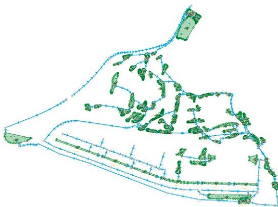
Ilustración 36. Ejemplo de modelo hidrológico-hidráulico de detalle de una cadena de SUDS (cunetas vegetadas, jardines de lluvia, conductos, elementos de rebose, etc.), desarrollado con el software InfoDrainage de AutoDesk. Fuente: Green Blue Management S.L. (Grupo TYPESA).
