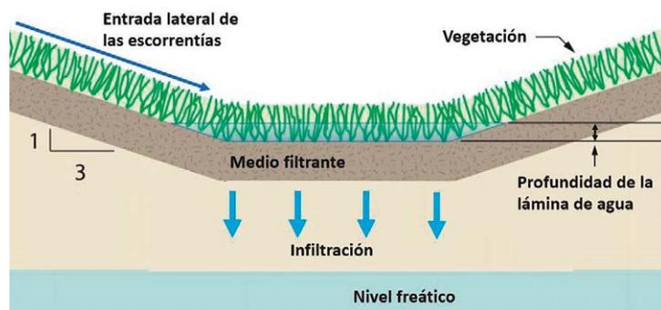
Ilustración 96. Esquema de una cuneta vegetada. Fuente: Adaptado de New Jersey Department of Environmental Protection Division of Watershed Management (2021). «Guía Básica para el Diseño de Sistemas Urbanos de Drenaje Sostenible en la Ciudad de València». Junio 2021.
