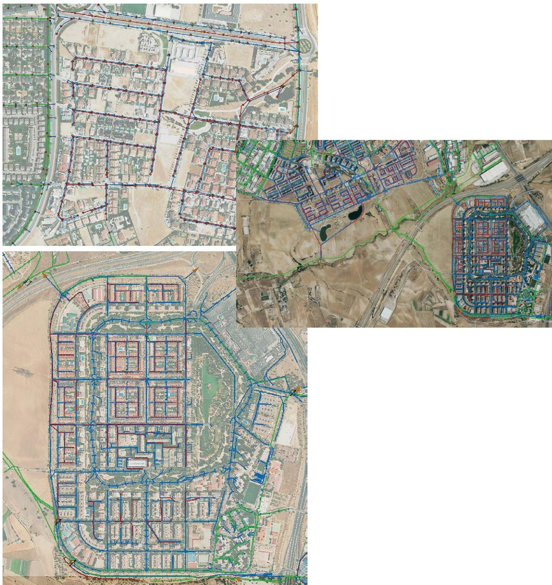
Ilustración 16. Ejemplos de red separativa en nueva zona residencial, con escorrentía pluvial vertiendo al medio receptor y, aguas residuales conectadas a la red unitaria principal. Fuente: Canal de Isabel II S.A.M.P.
