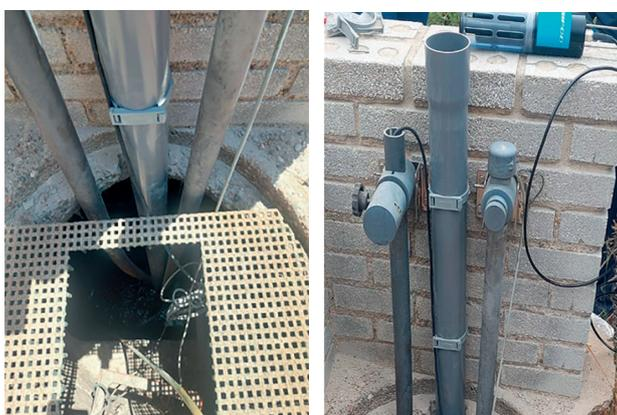
Ilustración 15. Control cuantitativo y cualitativo de los VDSS: Conjunto de sensor de nivel por ultrasonidos (US) para medir el caudal, sin contacto + Sonda multiparamétrica pH (pH; Redox; temperatura), conductividad [salinidad; Sólidos disueltos (TDS)] y turbidez (Turbidez; Sólidos en suspensión; temperatura) + Registrador de datos SOFREL DL4W (Data logger). Fuente: LACROIX SOFREL.
