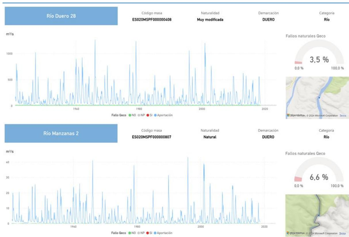
Figura 11. Ejemplos de comparación del régimen de caudales no alterados con los caudales mínimos
