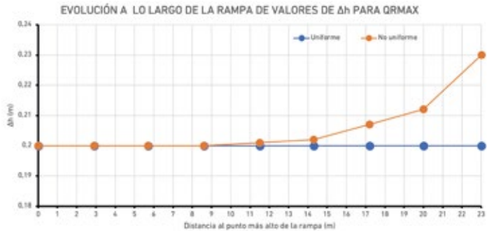
FIGURA 27 Para régimen no uniforme, dos módulos con zócalo, Q_{MAX} y h_{2,0}^u(Q_{MAX}) > h_2^u(Q_R(y=0)) = 0.3m , evolución de valores de \Delta h a lo largo de la rampa.
