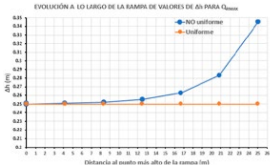
FIGURA 24 Evolución de valores de \Delta h a lo largo de la rampa para régimen no uniforme circulando Q_{RMAX} y con h_{2,n}^{no\ U}(Q_{RMAX}) = h_2^U(Q_R(y=0)) = 0.35m (Los puntos se corresponden con la situación de las hiladas de bolos)
