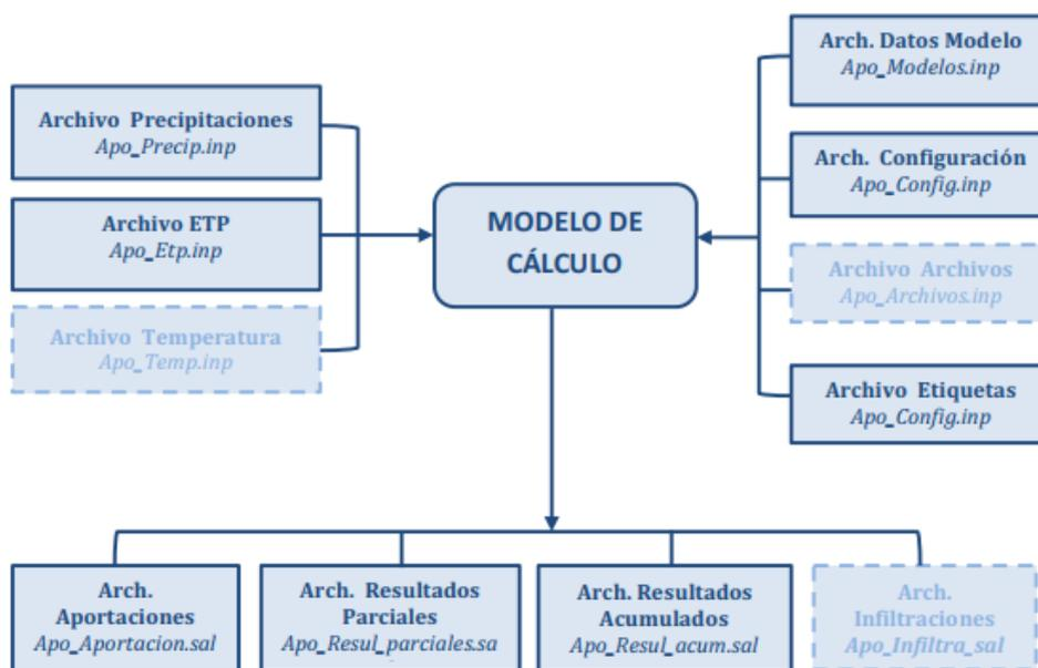
Figura 11. Esquema de funcionamiento de EVALHID
