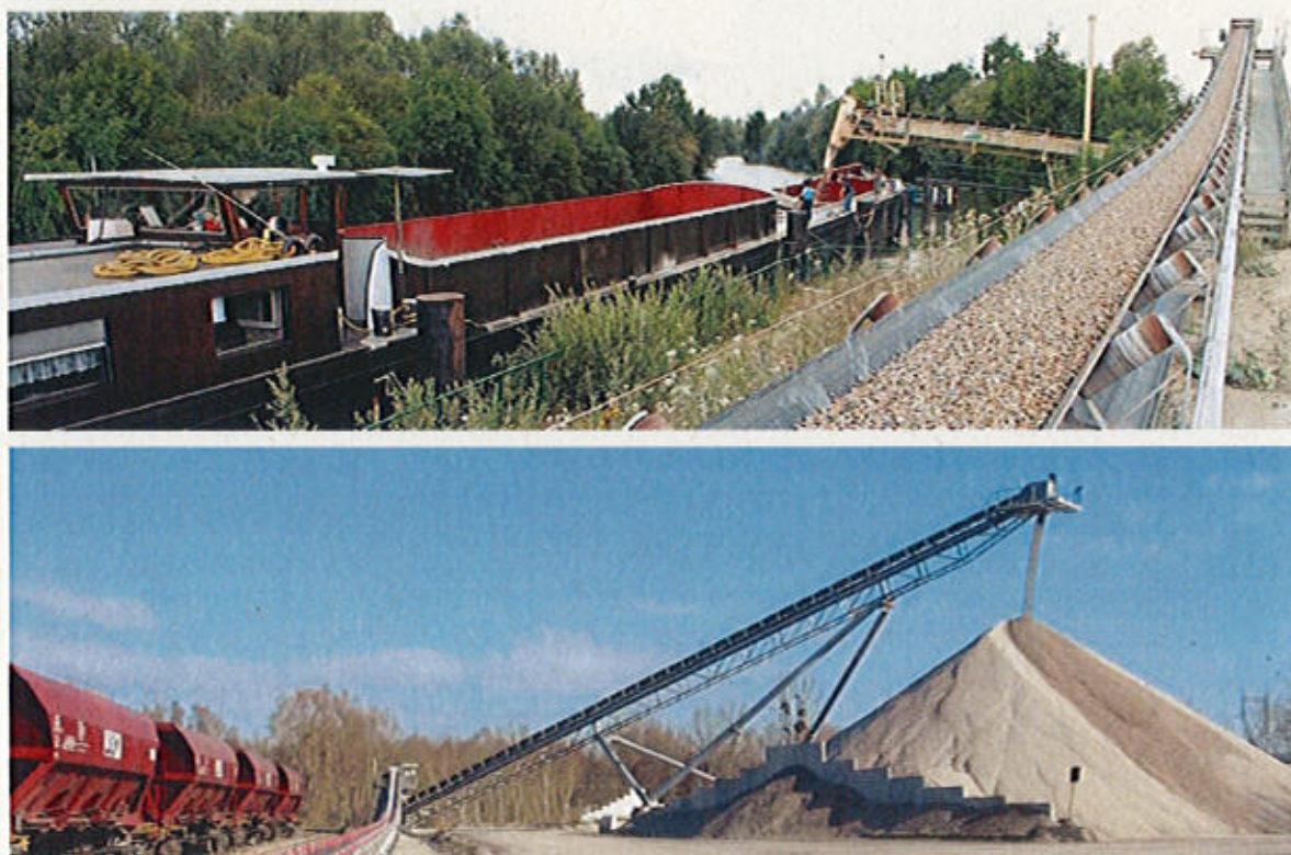
Ilustración 15: Carga de áridos en barcaza y en ferrocarril
