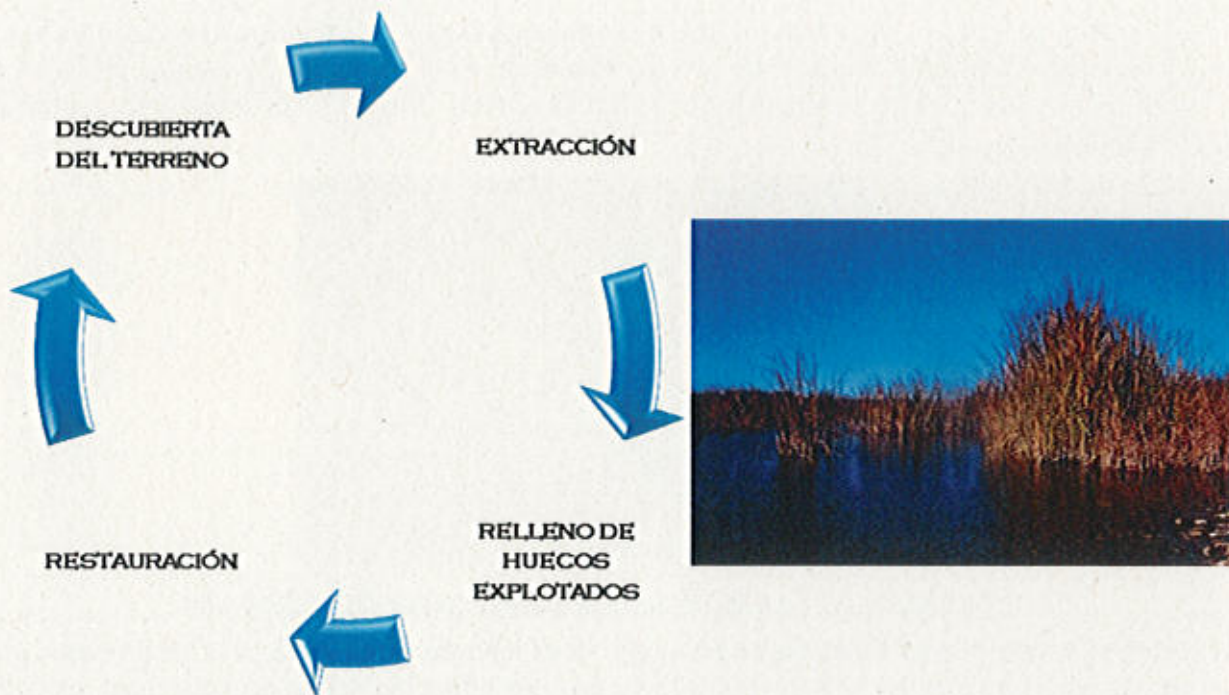
Ilustración 9: Esquema metodología de la minería de transferencia
