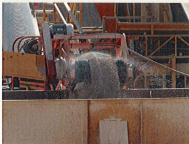
Ilustración 45: Lavado de la grava
