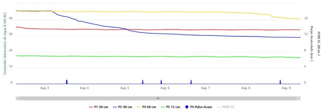
Gráfico 1: Evolución de la lámina de agua aplicada en un riego con dosis de un RIEGO A MANTA (TRADICIONAL) en un girasol en Santoyo (Palencia)
