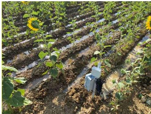
**Foto 1:** Equipo de Sonda de Humedad instalado por la C.R. Canal del Pisuega. Riego a manta en Girasol.
