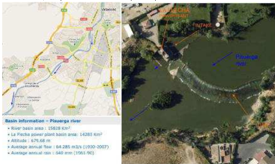
Figura núm. 1. Localización y vista aérea de la C.H. La Flecha. Fuente: Spanish Hydro Power Plants – Main Technical Characteristics.
