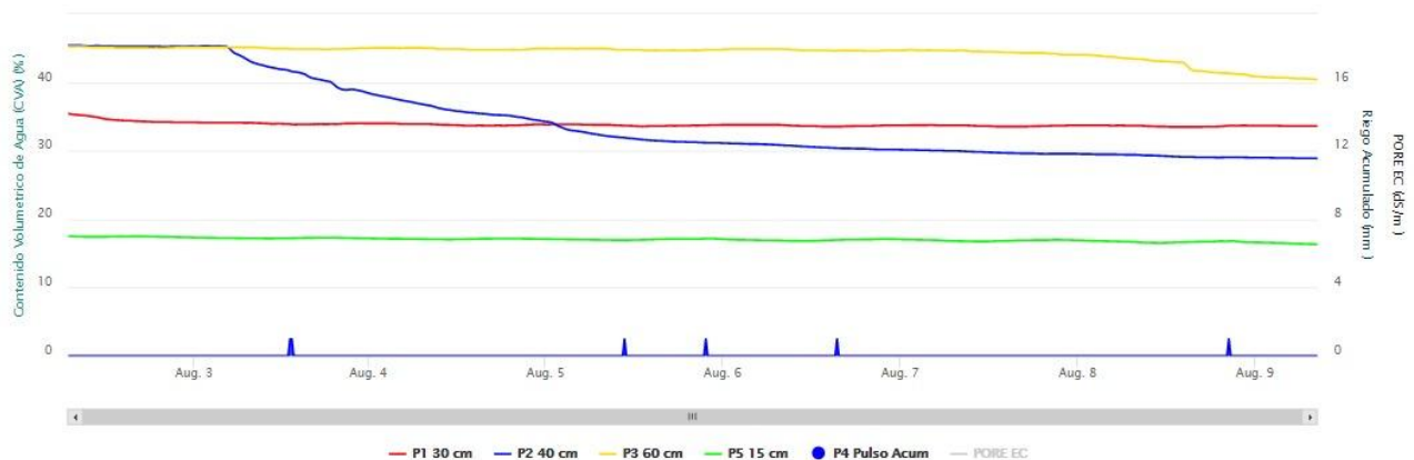
Gráfico 1: Evolución de la lámina de agua aplicada en un riego con dosis de un RIEGO A MANTA (TRADICIONAL) en un girasol en Santoyo (Palencia)
