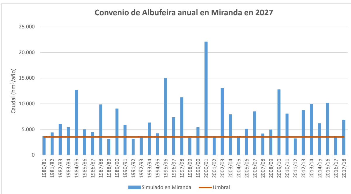
Figura 410. Convenio de Albufeira anual en Miranda en el horizonte 2027: comparación del caudal anual obtenido en la simulación con el caudal mínimo de convenio
