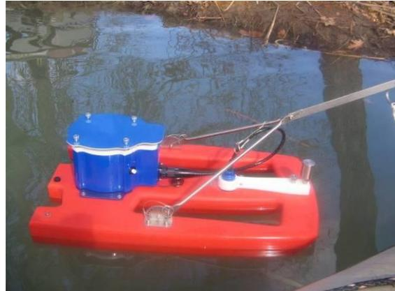
Caudalímetro aforador batimétrico
