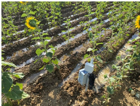
Foto 1: Equipo de Sonda de Humedad instalado por la C.R. Canal del Pisuerga. Riego a manta en Girasol.
