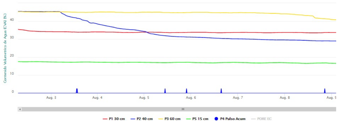
Gráfico 1. Evolución de la lámina de agua aplicada en un riego con dosis de un RIEGO A MANTA (TRADICIONAL) en un girasol en Santoyo (Palencia)
