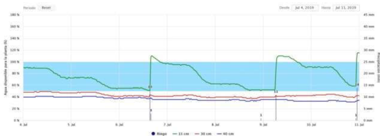
Gráfico 2: Evolución de la lámina de agua aplicada en un riego con dosis ajustadas a las necesidades del cultivo, en este caso maíz.
