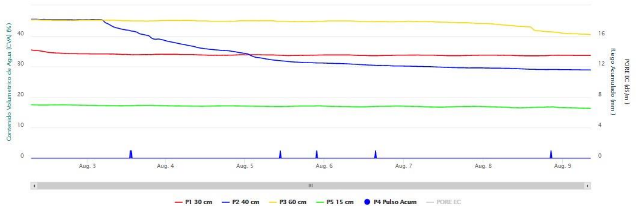
Gráfico 1: Evolución de la lámina de agua aplicada en un riego con dosis de un RIEGO A MANTA (TRADICIONAL) en un girasol en Santoyo (Palencia)
