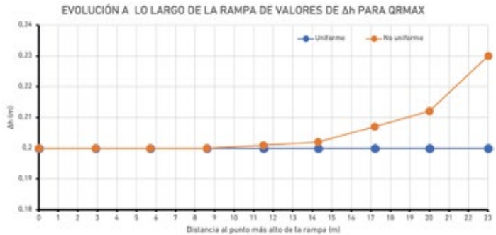
FIGURA 27 Para régimen no uniforme, dos módulos con zócalo, Q_{RMAX} y h_{2,0}^u(Q_{RMAX}) > h_{2,0}^u(Q_R(y=0)) = 0.3m , evolución de valores de \Delta h a lo largo de la rampa.
