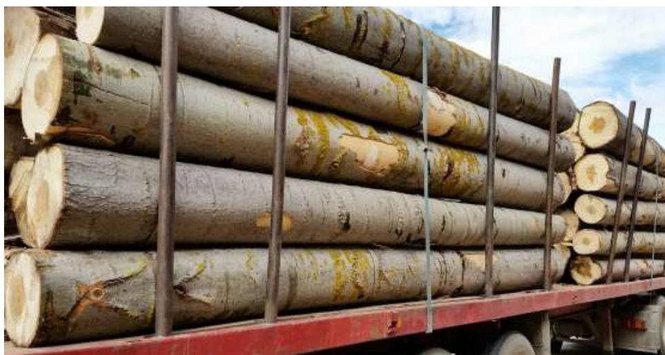
Figura 28. Madera en rollo de chopo con destino a la producción de tablero contrachapado.
