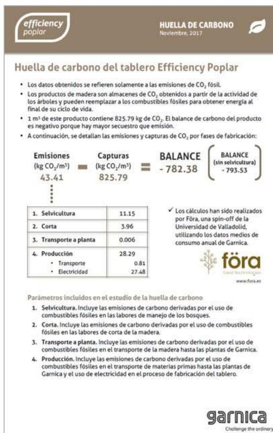
Figura 18. Huella de carbono del tablero Efficiency Poplar.
