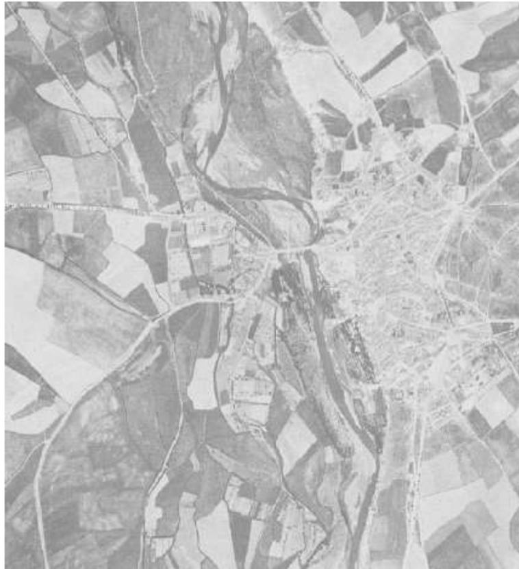
**Figura 7:** Estado del cauce del río Carrión en 1946, en Carrión de los Condes. Se observa su trazado trenzado y meandriforme con diversos cauces y una amplia zona de afección fluvial, totalmente desprovista de vegetación ribereña capaz de estabilizar y consolidar los márgenes. (Fuente: IGN)
