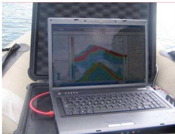
**Toma de datos del cauce mediante ecosonda acoplada a embarcación**
