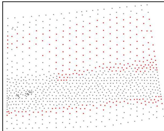
Al fusionar las capas de velocidad y profundidad con las restricciones impuestas para los alevines, se obtiene la imagen que muestra en rojo la distribución de zonas de refugio, permitiendo visualizar la existencia de conectividad en el tramo.
