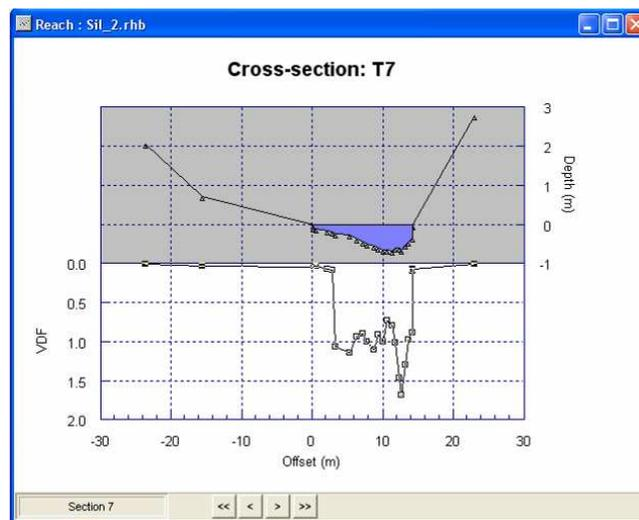
**Detalle de la calibración de los VDF's de una sección (transecto)**
