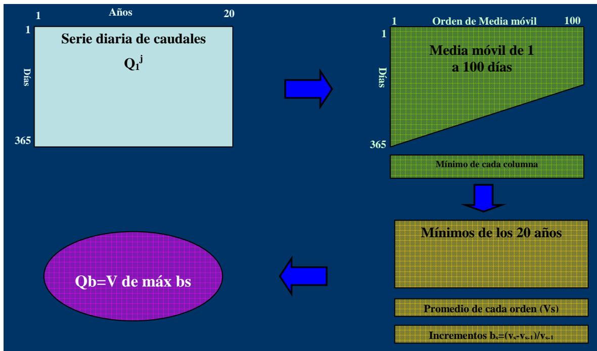
**Esquema del proceso del cálculo del caudal básico**
