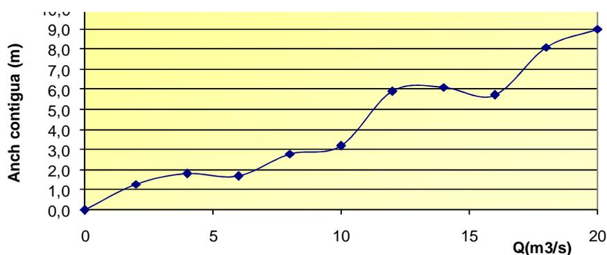
En el caso de tramos bidimensionales, se ha observado espacialmente si existe o no conectividad, y para qué caudal se rompe, como se puede observar en el ejemplo que se muestra a continuación, solapando las capas de velocidad/profundidad:
