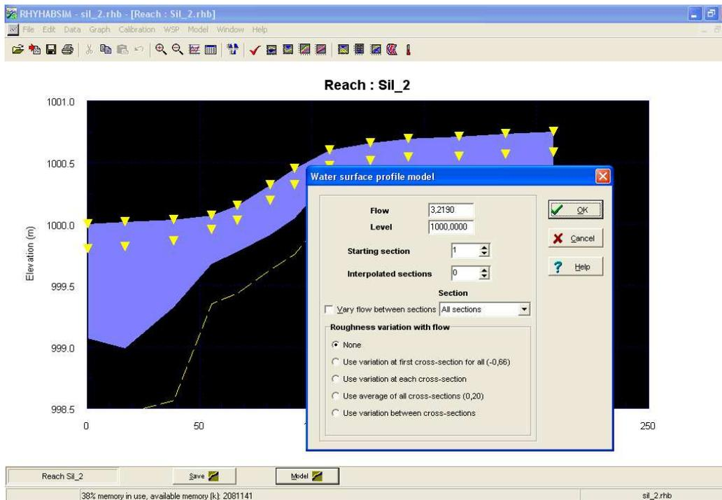
Detalle la Simulación del perfil longitudinal de la lámina de agua
