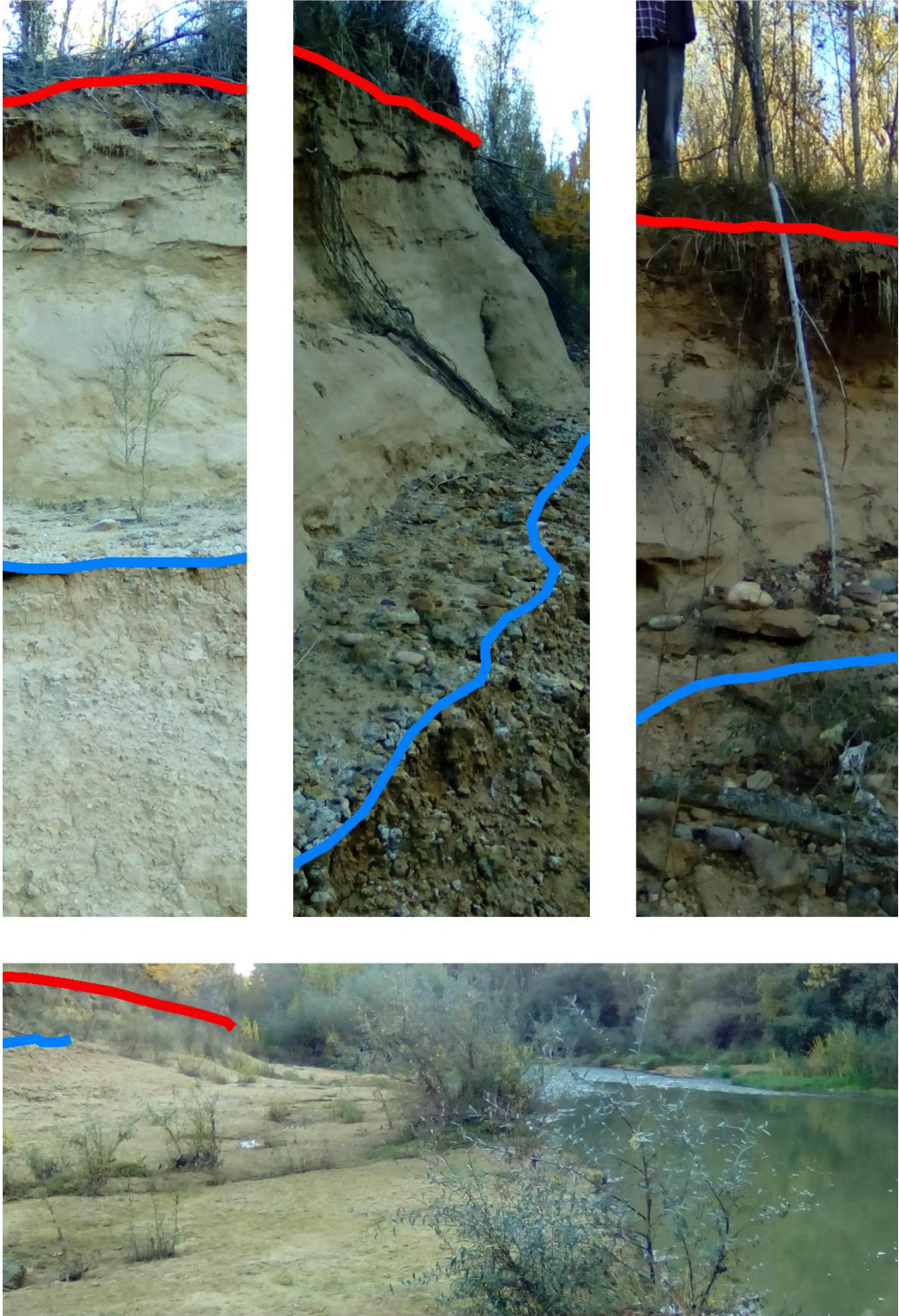
Figura 26. Arriba: tres vistas del talud, casi vertical, de la margen izquierda del río. Abajo: vista desde aguas arriba del río. Las líneas rojas y azules indican los mismos elementos en las distintas fotografías. La línea roja indica el punto más elevado del lecho incidido y la línea azul
