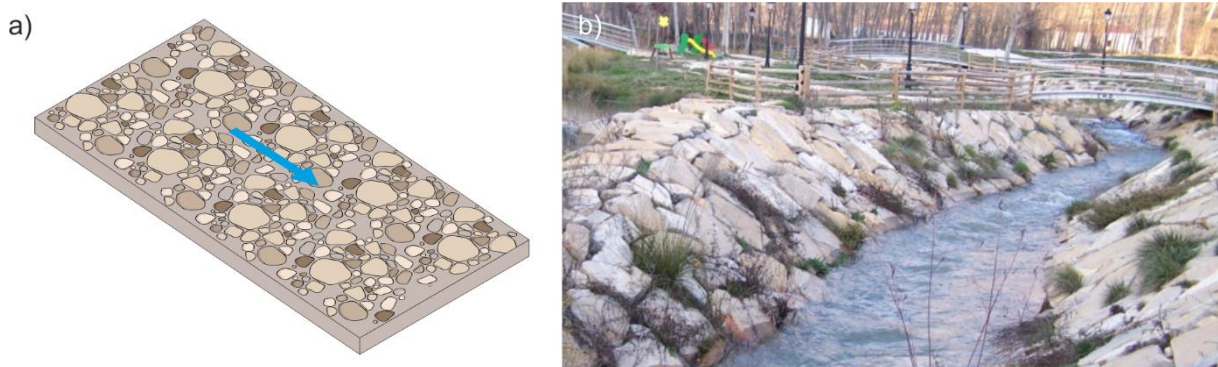
FIGURA 22. CONSTRUCCIONES DE RUGOSIDAD UNIFORME.
